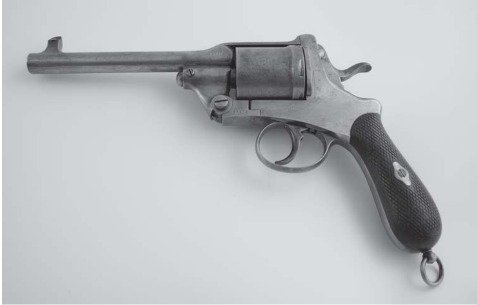
Fig. 1 - Rivoltella Gasser basculante M. 1877, lato sinistro (MGR, foto M. Leonardi)
