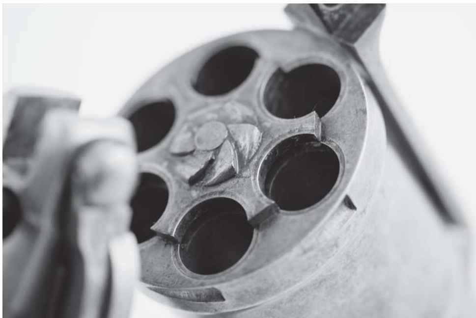
Fig. 6 - Rivoltella Gasser basculante M. 1877, particolare della rosa di rotazione-estrattore (MGR, foto M. Leonardi)
