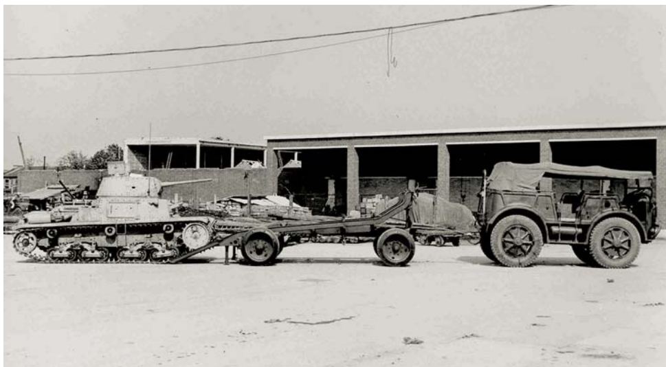
Fig. 9 - TM40 utilizzato per il traino dei carrelli Viberti destinati al trasporto dei carri armati durante i lunghi tragitti di spostamento, per evitare un'eccessiva e inutile usura dei delicati organi propri del mezzo da combattimento.
