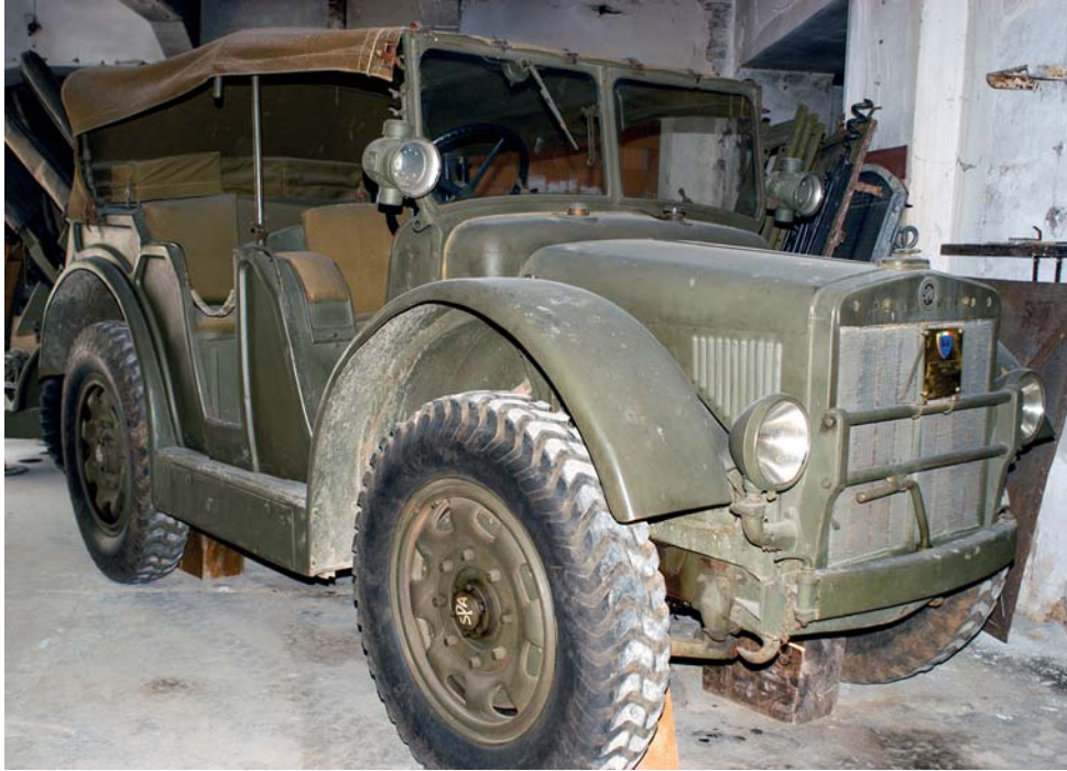
Fig. 5 - Il mezzo parcheggiato presso il deposito del Museo, munito di quattro ruote pneumatiche con pneumatico "Artiglio"; è poggiato su quattro plinti di legno per preservare i pneumatici stessi ed evitare che si affloschino sotto il peso del mezzo. Notare la capotina in tela cerata in posizione rialzata, che aiuta anche a proteggere il mezzo dalla polvere.
