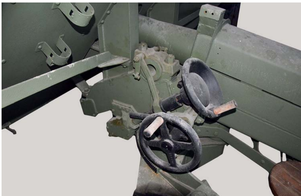
Particolare dei due volantini di direzione dell'alzo, sopra, e del brandeggio, sotto.
