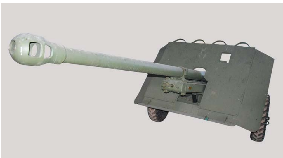
Vista frontale del pezzo controcarro con in primo piano ben visibile il freno di bocca a due luci.
