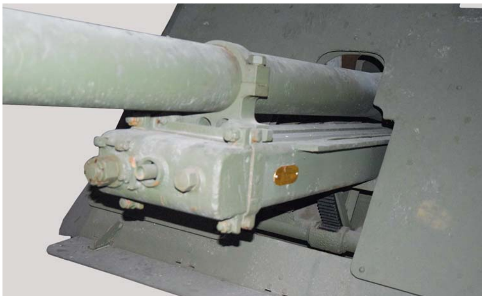
Vista di dettaglio dello sportello della culla, con i dadi di unione dell'asta del freno, a sinistra, e dell'asta del recuperatore, a destra; al centro il "coperchio di spia" dell'asta di controllo.
