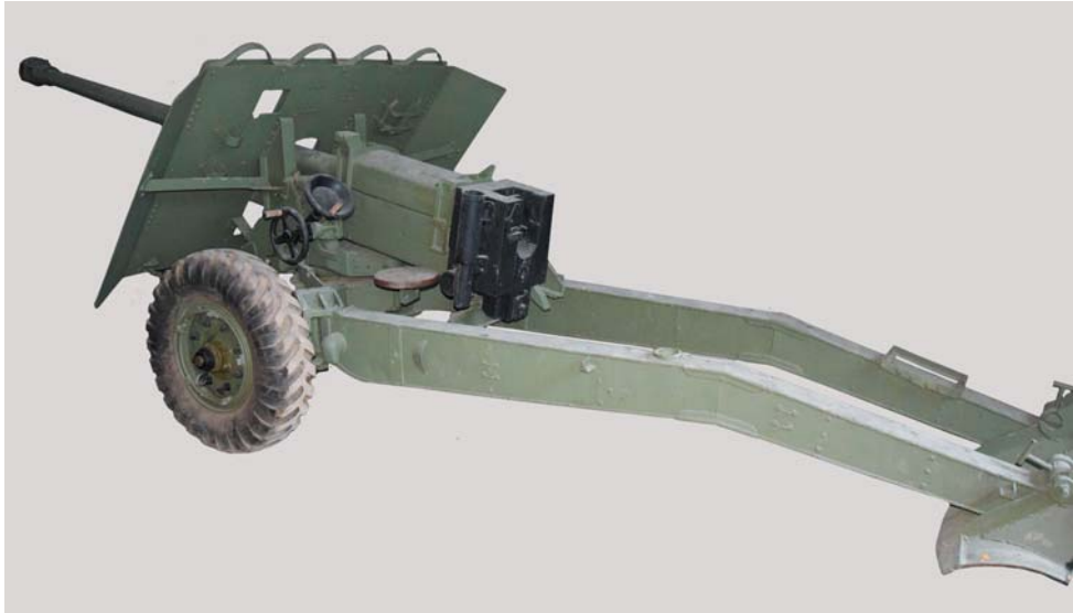
Vista di 3/4 posteriore del 76/55, dove, tra le altre cose, su può notare la forma a gomito delle code.
