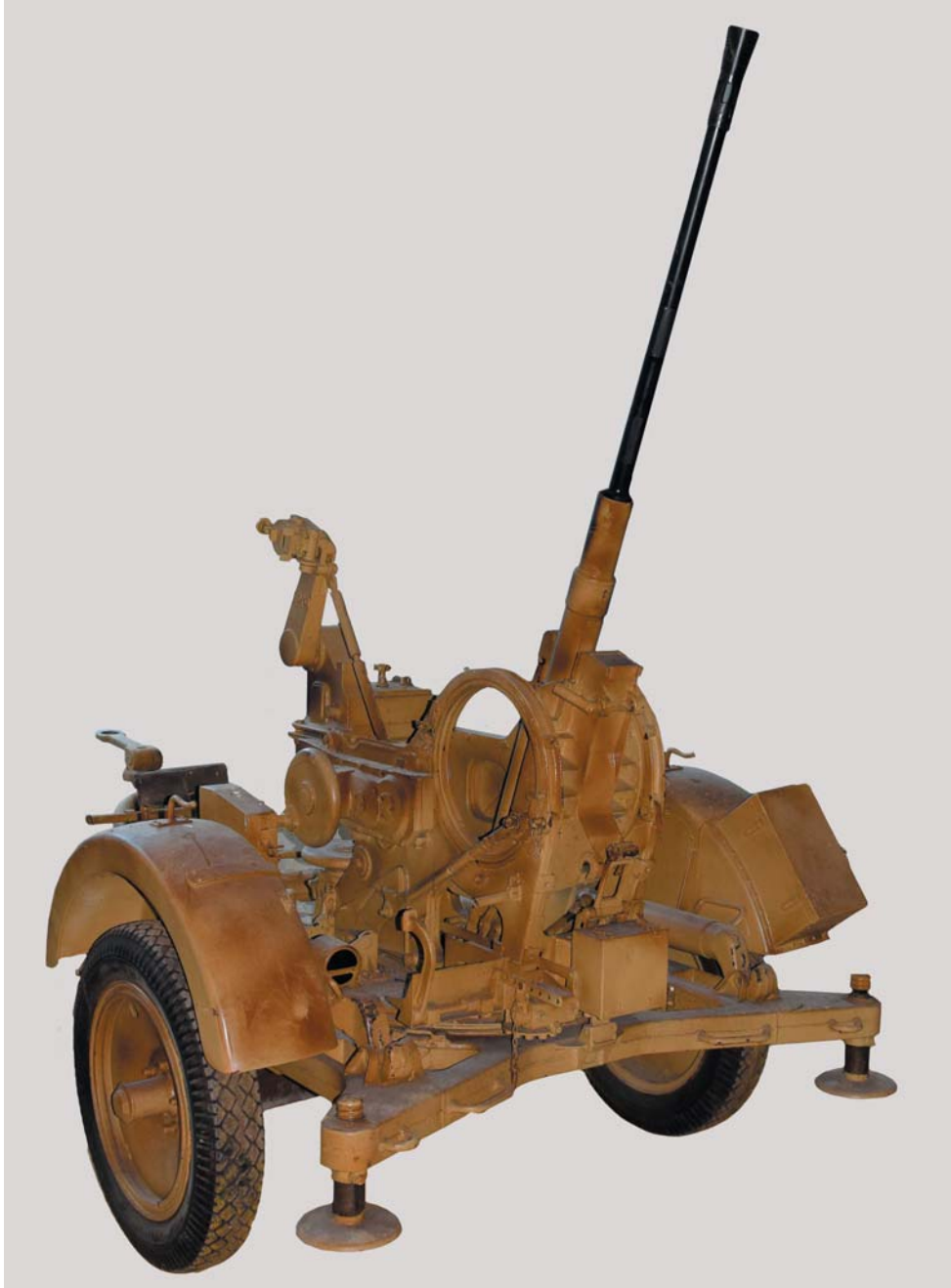
Fig. 2 - La Flak 38 alla sua massima elevazione. Ben visibile la cremagliera di innalzamento.
