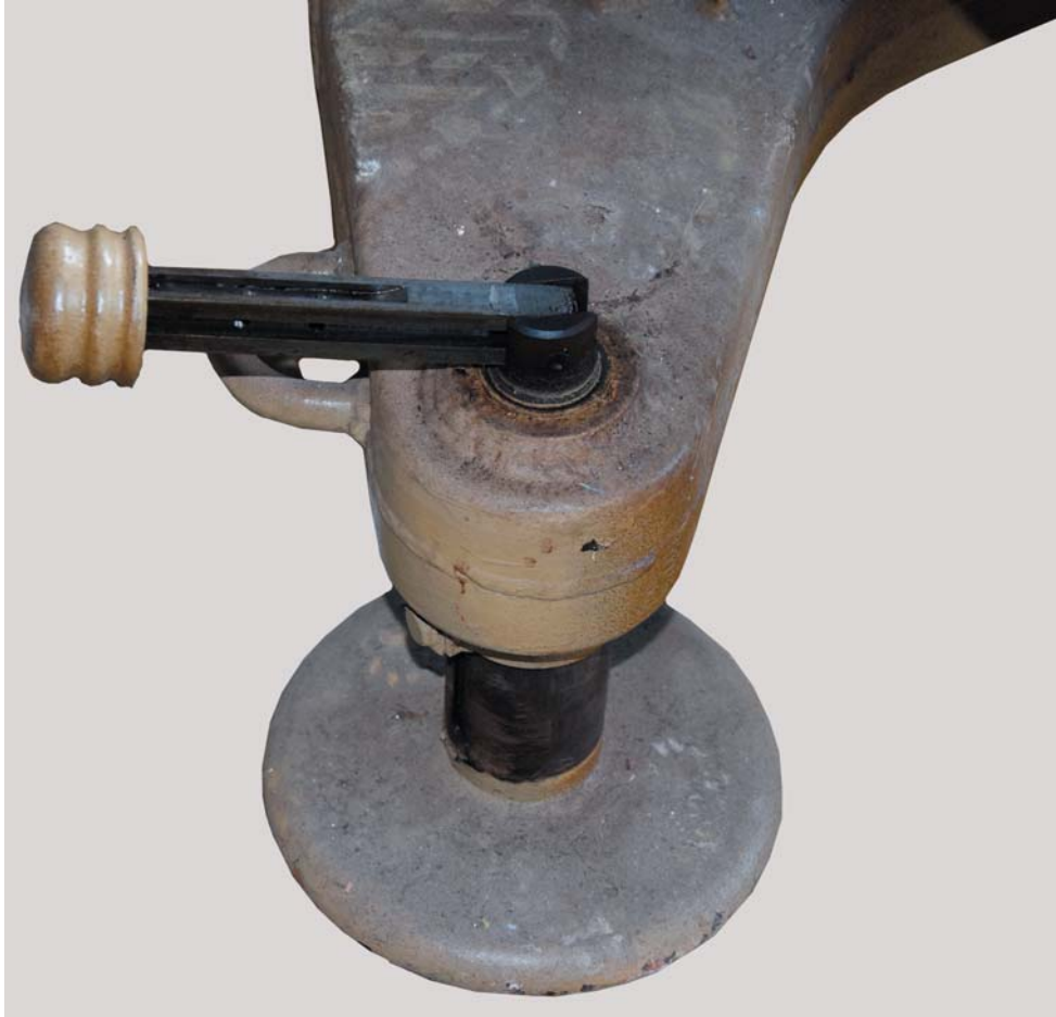
Fig. 12 - Dettaglio della manovella di posizionamento del cannone.
