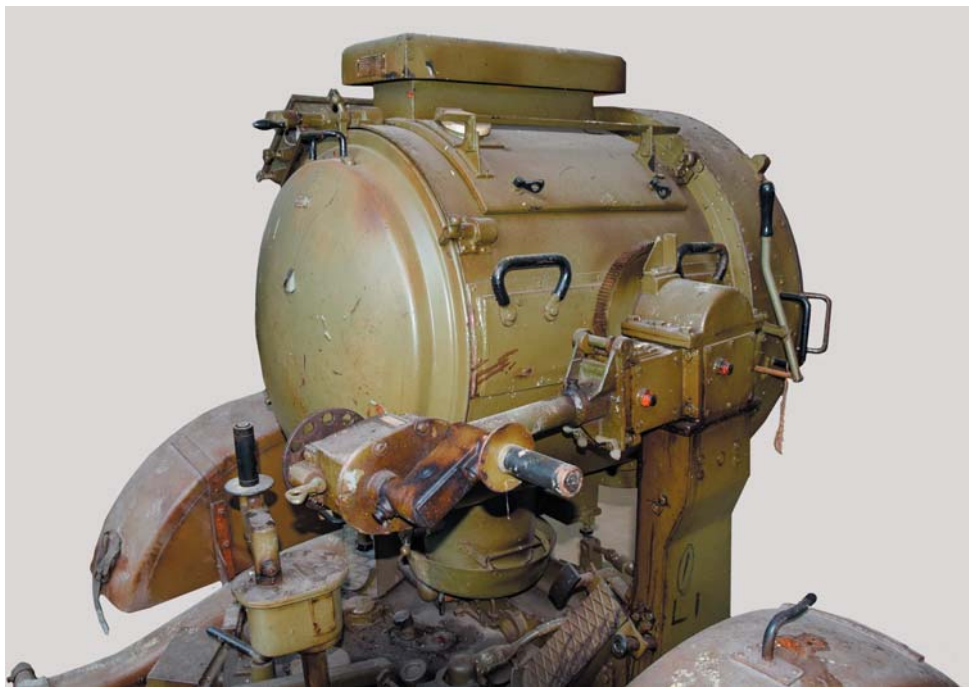
Fig. 8 - Dettaglio del sistema di elevazione della fotoelettrica.
