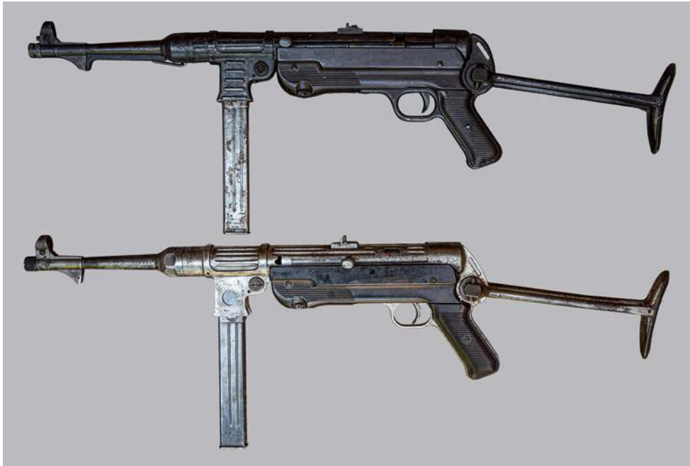
Confronto tra MP38 (sotto) ed MP40 della collezione del Museo della Guerra di Rovereto che evidenzia le differenze costruttive esterne. Il caricatore dell'MP38 non è completamente inserito nel bocchettone (foto Luigi Carretta).
