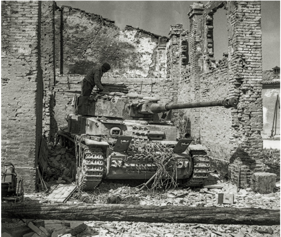
Soldato alleato ispeziona un carro tedesco Panzer IV Ausf. H, armato con cannone da 7,5 cm PaK 40 L/48, abbandonato in una postazione difensiva fra le rovine di un abitato, fronte italiano 1943-1944 (MSIG, Archivio fotografico, 310/195).
