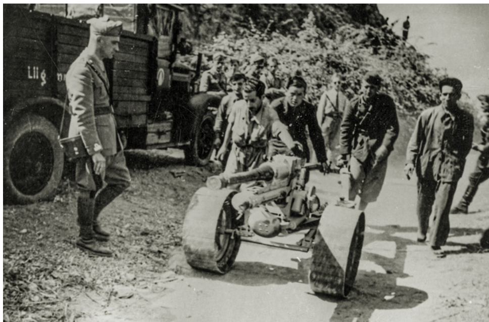
Cannone anticarro da 47/32 del Regio Esercito dotato di un singolare sistema di copertura delle ruote, utilizzato probabilmente per aumentare la stabilità del pezzo sui terreni sabbiosi, fronte nordafricano 1941-1942 (Archivio MSIG 313-166).
