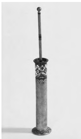
5. Bottiglia di Leida decorata (fine del XVIII secolo, non firmata) (Gabinetto di fisica, Università di Pavia).
