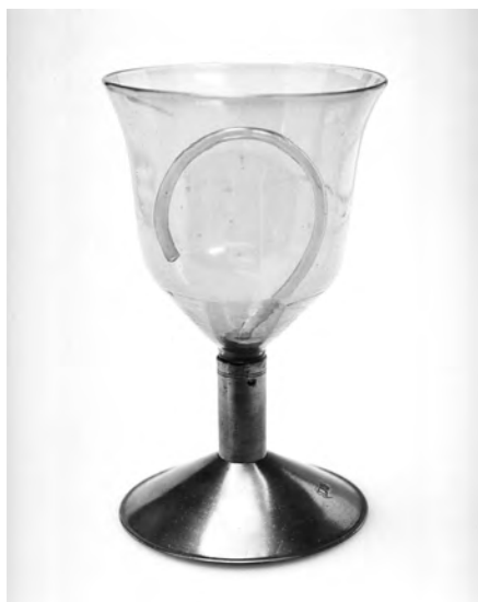
6. Vaso di Tantalo o bicchiere da diabeto. 'Gioco idrostatico' per dimostrare il funzionamento del sifone (fine secolo XVIII, non firmato) (Gabinetto di fisica, Università di Pavia).
