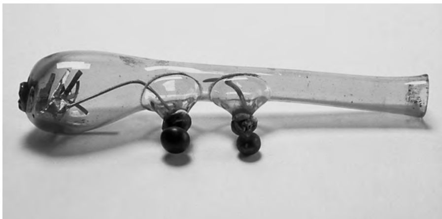
1. Pistola elettro-flogopneumatica. Lo strumento inventato da Volta nel 1777 fu utilizzato negli studi sulla combustione delle arie infiammabili (ultimo quarto del XVIII secolo, non firmata) (Gabinetto di fisica, Università di Pavia).
