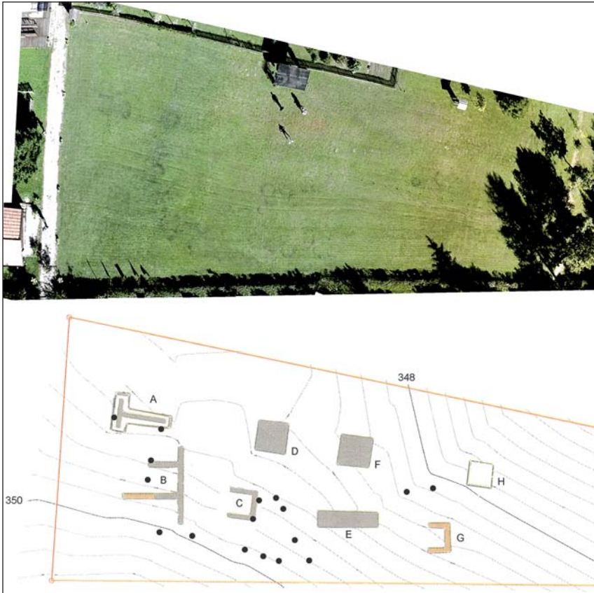
Fig. 5 - Indagini di telerilevamento sul prato che ospita l'Area Test messa a punto nel 2004 dalla Fondazione Museo Civico su una zona resa disponibile dal Comune di Rovereto (Bosco della Città, ex vivaio comunale). Si noti come dalla semplice immagine nel visibile si rilevi la presenza di una serie di anomalie, quelle legate ai target sepolti sono però visibili solo ad un occhio allenato mentre sono ben leggibili le sagome di forma circolare (identificate sulla base planimetrica sottostante con pallini neri) dovute a scariche elettriche (fulmini).
